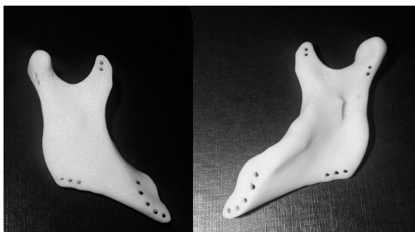
Rys. 8. Gotowy implant indywidualny wykonany technologią druku 3D
